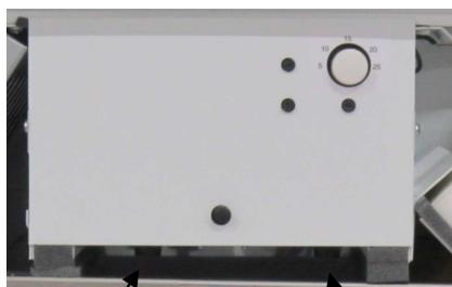
etulämmittimen ylilämpösuoja      jälkilämmittimen ylilämpösuoja
