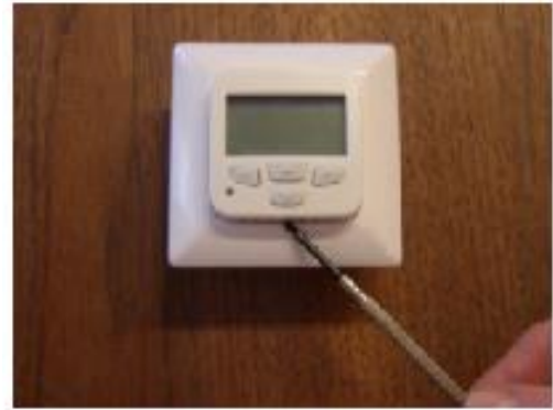
Bild 8: Borttagningen av kontrollpanelens täckplåten
